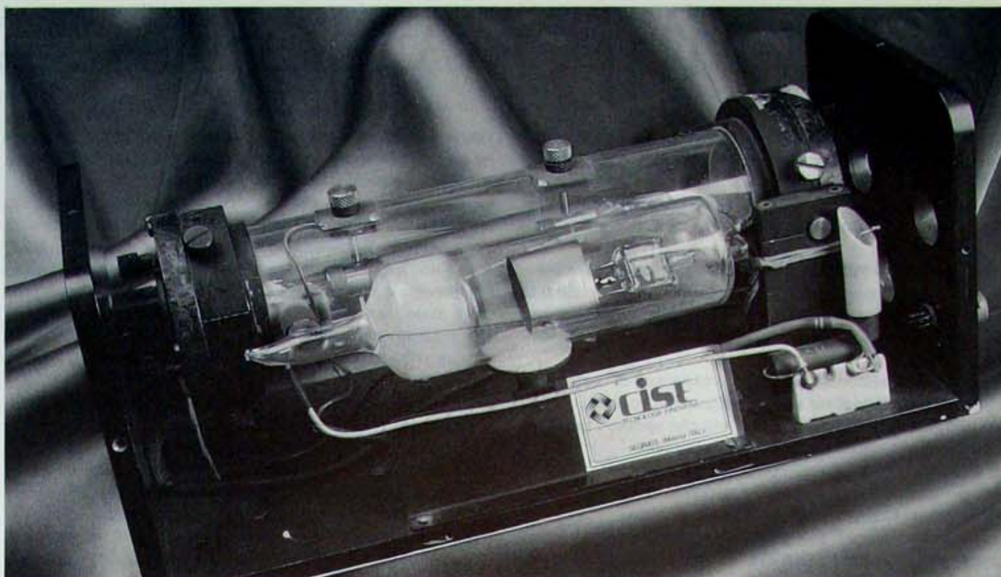
Primo laser stabilizzato in frequenza per misure di distanza con tecniche interferometriche, costruito negli anni 1962-1963 presso i laboratori del CISE-Tecnologie Innovative, di Milano-Segrate.
